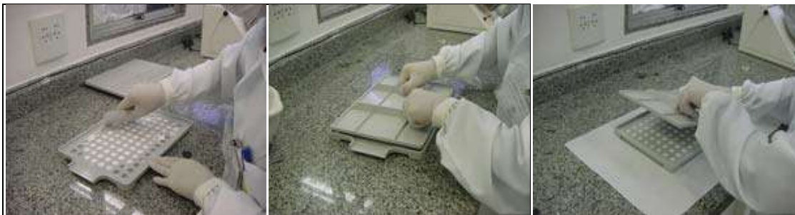
Figura 4. Preenchimento das cavidades e compactação
