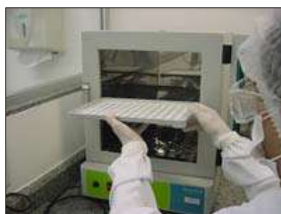
Figura 5. Aquecimento do molde preenchido.
